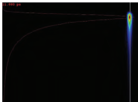
Рис. 3. Спектр времяразрешенной микроФЛ структуры \text{hBN-WSe}_2\text{-hBN} при температуре T=10 К, и нерезонансном возбуждении \text{Ti:Sp} лазером. Характерное время затухания ФЛ экситона \sim 12 пс
