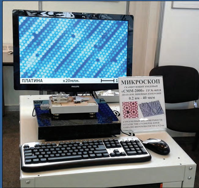
Сканирующий зондовый микроскоп СММ-2000 атомное разрешение в СТМ / АСМ, поле до 40 / 40 / 5 мкм, 25 режимов, -20...+150 С
