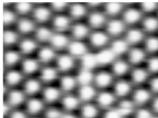
Рис.2 СТМ изображение локального объекта – кродуина внутри решетки (\sqrt{3} \times \sqrt{3})R30^\circ . Искажение решетки вызвано добавлением одного атома хлора.
