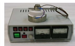
Магнетрон МАГ-2000 с блоком управления
