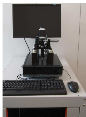
AFM с машиной разрыва
