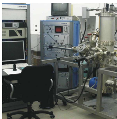
UHV-cryo-STM, 5K, 10 -11 мбар
