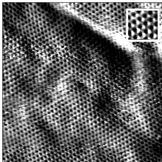
Рис. 1. Токовое изображение атомной структуры на участке  $10 \times 10 \text{ нм}^2$  графитовой пленки после интеркалирования под нее атомов цезия. На вставке приведен участок, на котором явно видно, что величина туннельного тока над атомом зависит от его положения в ячейке.
