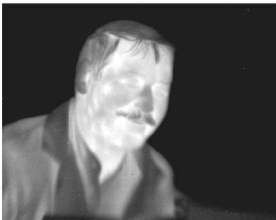
Рис.5 Пример тепловизионного изображения, полученного с использованием матрицы формата 320x256
