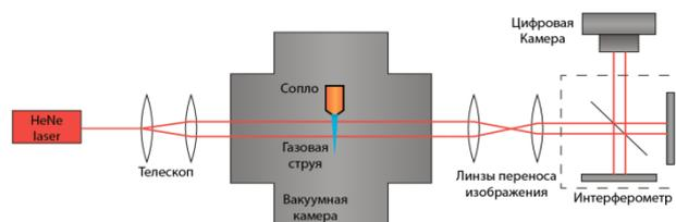
Рис. 1. Схема эксперимента по интерферометрическим измерениям газовых струй
