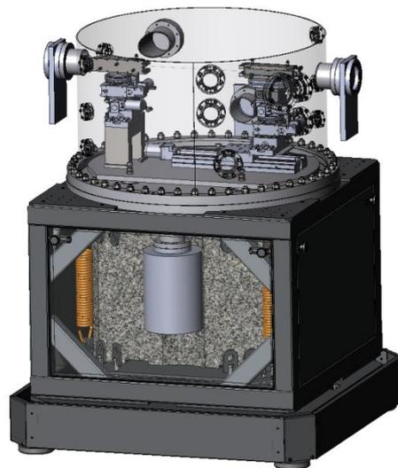
Рис. 1. Эскиз зеркального монохроматора, с вакуумной камерой, рамой и пьедесталом для первичной настройки на пучок
