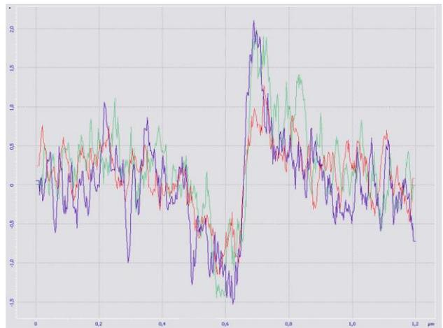
**Рис. 5.** Экспериментально измеренные сечения МСМ-контраста около свободного края (красная кривая на рис. 4, б), в середине (зеленая кривая) и у края с перемычкой (фиолетовая кривая)
