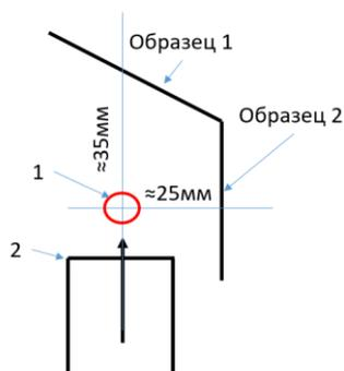
Рис. 1. Схема эксперимента (1 – область фокусировки лазера, 2 – сопло)
