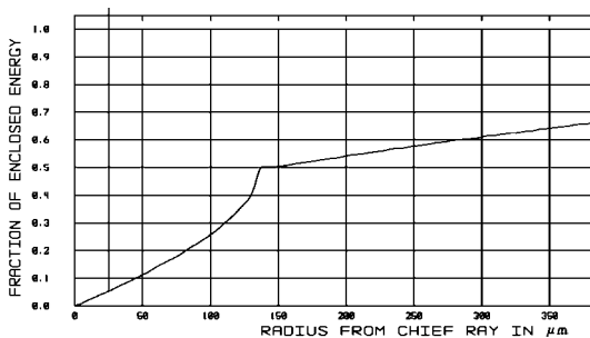
Рис. 1. Расчетная мощность в зависимости от полуширины щели детектора для исходной линзы с апертурой 44 мм.
