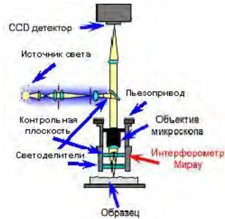
Рис.2. Схема интерферометра Talysurf CCI 2000
