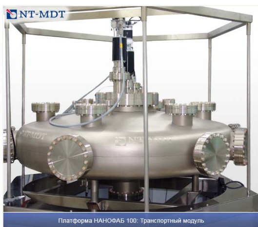
Рис. 5. Фотографии радиальных транспортных модулей систем НАНОФАБ-100 (слева) и НАНОФАБ-25
