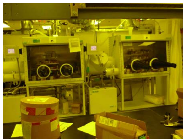
Рис. 3. Исследовательская линия для изготовления органических светоизлучающих экранов (OLED) в инертной среде университета Аризоны.
