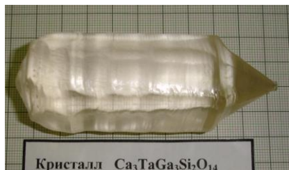
Рис. 1. Кристалл CTGS, выращенный вдоль оси c методом Чохральского
