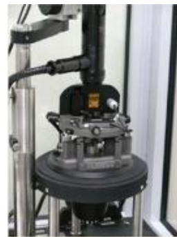
Рис. 3. Атомно-силовой микроскоп Solver PRO-M (“NNT-MDT”, Россия). Латеральное разрешение 8 нм, по нормали 0,1 нм. Максимальный размер скана 100×100 мкм
