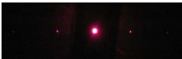
Рис. 2. Дифракция оптического излучения на доменной структуре с периодом 1 мкм
