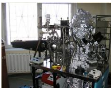
Рис. 8. Электронный спектрометр “KRATOS”. В качестве источника рентгеновского излучения была использована мишень из Mg. В эмиссионных спектрах доминируют дублеты Kα
